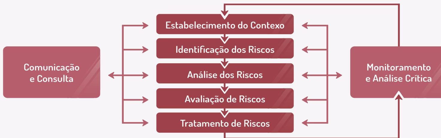
FIGURA 4: PROCESSO DE GERENCIAMENTO DE RISCOS. ADAPTADO DA ABNT NBR ISO 31000:2018.
